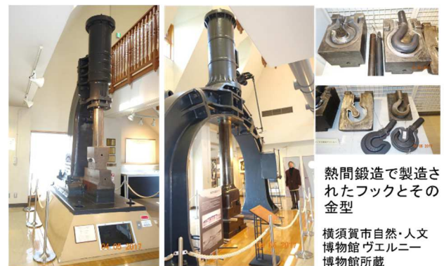
図 32.7 0.5トンの蒸気ハンマー（左）と3トンの蒸気ハンマー（右）
